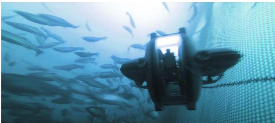
Deep Trekker fabrica herramientas de inspección submarinas portátiles como el DTX2 ROV – un vehículo submarino operado
