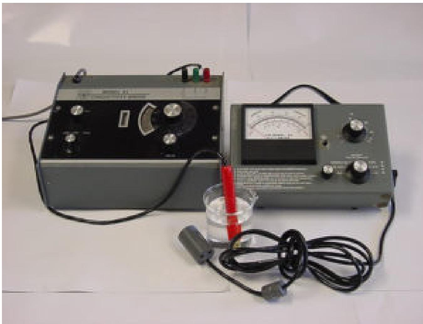
Fig. 1: Un medidor de conductividad de banco de laboratorio (izquierda) y un medidor de conductividad portátil (derecha).
