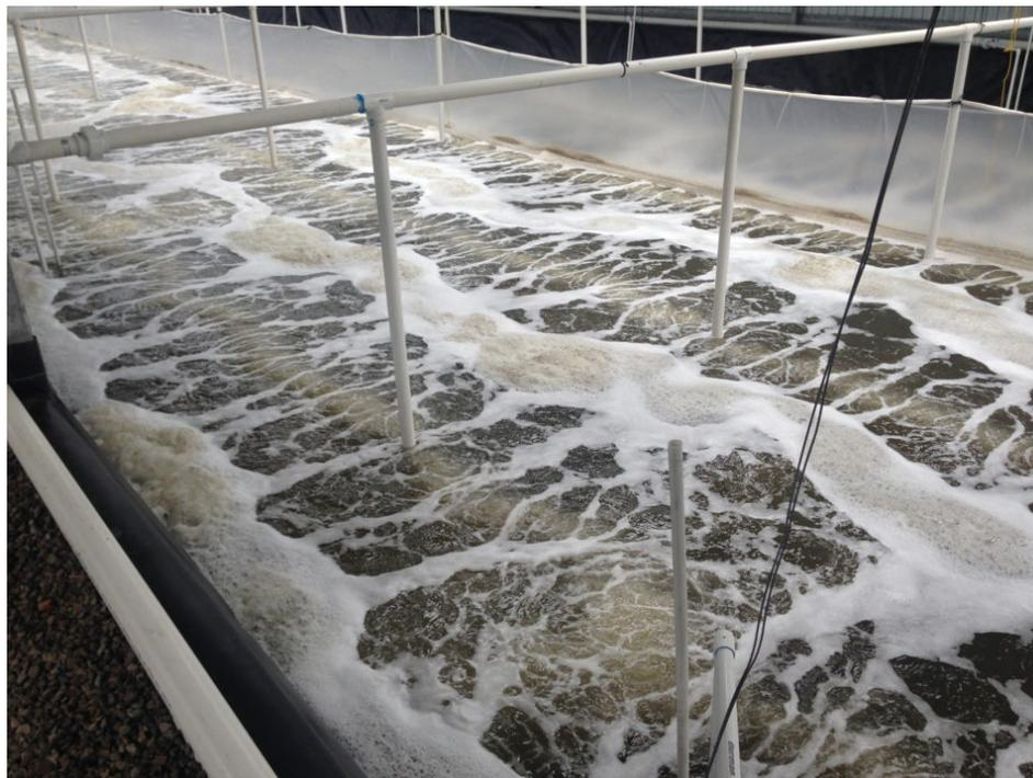
Una aireación confiable e ininterrumpida es un componente crítico de los sistemas de pre-criaderos de camarón.
