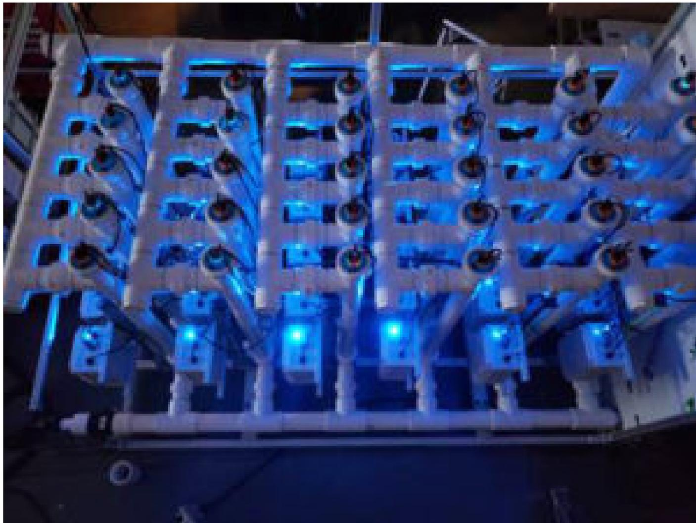
Una mirada al reactor Exciton Clean, que utiliza luz ultravioleta germicida combinada con tecnología de nanotubos para producir radicales hidroxilo fotocatalíticos, acelerando la oxidación de contaminantes biológicos y químicos en el agua. Foto de cortesía.
