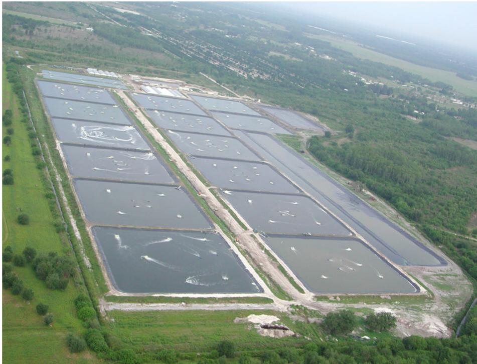
La salinización de los suelos y aguas tierra adentro es una consideración cuando las granjas de camarón se construyen lejos de la costa. Las alternativas de manejo incluyen la instalación de granjas en áreas con suelos con una distribución de tamaño de partículas adecuada, o el uso de revestimientos de plástico – como se ve en esta vista aérea de una granja de camarón tierra adentro – para resistir la filtración e impedir la salinización.
