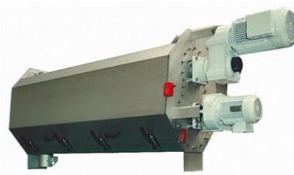
Muchos pre-acondicionadores tienen una alta mezcla radial en una cámara donde se inyectan vapor y agua. En una segunda cámara, se produce más mezcla axial y las harinas de ingredientes se hidratan allí. Imágenes cortesía de Bühler.
