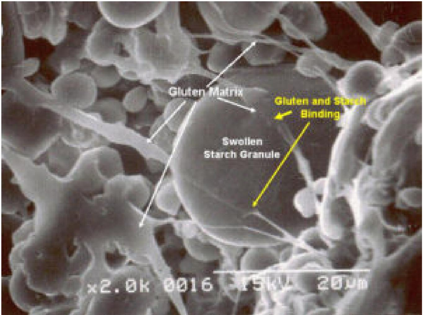
Micrografía de exploración electrónica de la interacción del almidón de gluten, que muestra las fibrillas de la matriz de formación de gluten.
