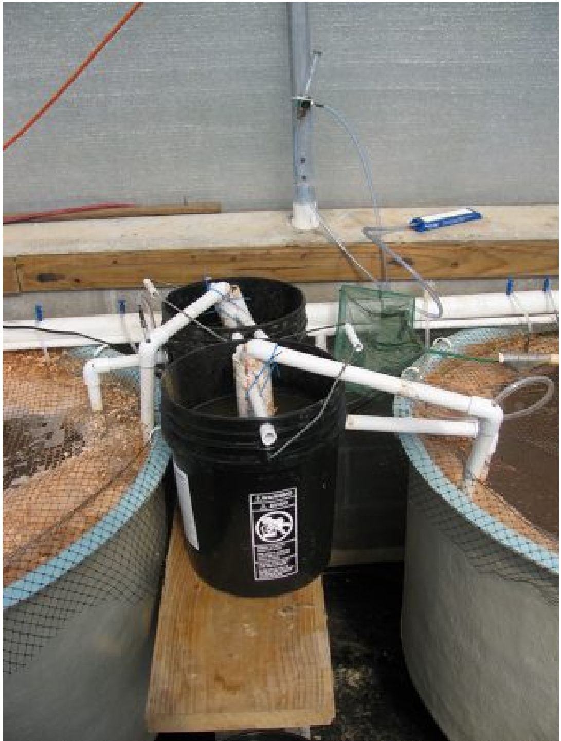
Una de las cámaras de sedimentación usadas en el estudio para remover sólidos.
