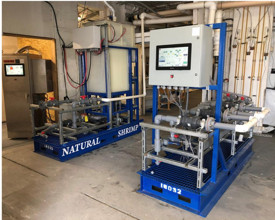
La empresa con sede en Texas NaturalShrimp utiliza una carga eléctrica ligera, un proceso llamado electrocoagulación, para eliminar y controlar las bacterias, el amoníaco y otros contaminantes que dificultan la producción de camarones. Foto de cortesía.
